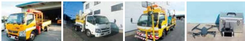
3tユニック車      橋梁点検車      ラインマーカー車      ドローン
